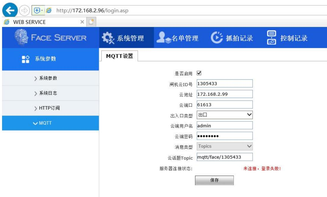
2. mqttbox 添加发布者后填写发布话题，填写需要发布的 Topic（话题），例如：mqtt/face/**ID**，此话题即 mqttbox 客户端下发信息给人脸识别一体机的话题，其中 ID 可以是人脸识别一体机的本机 ID（唯一且区别不同机器），可参照下面数据内容填入。
